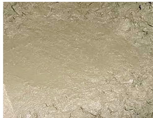
Figura 11 – Exemplo de concreto com “ideal” teor de argamassa.
