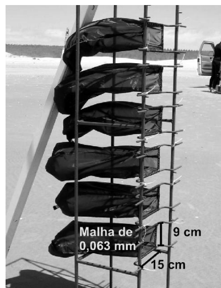
Figura 2 - Estrutura onde são presas as armadilhas.
