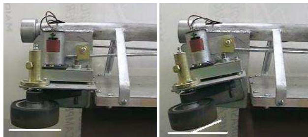
Figura 4: Eixo de rotação nas rodas motrizes
