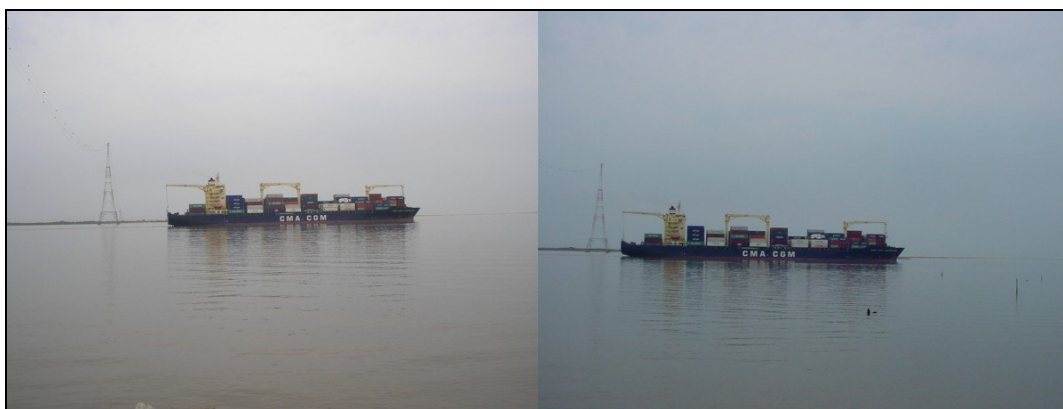
Figura 3 – Par de fotografias de uma embarcação utilizada no processo de métrica estereoscópica
