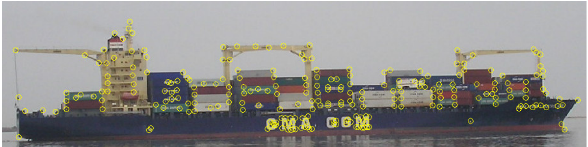
Figura 4 – Pontos utilizados no processamento fotogramétrico e cujas posições foram estimadas
