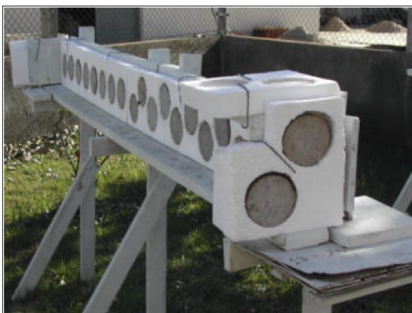
Figura 2. Rack com testemunhos para a medição do GS desta e de outras pesquisas
